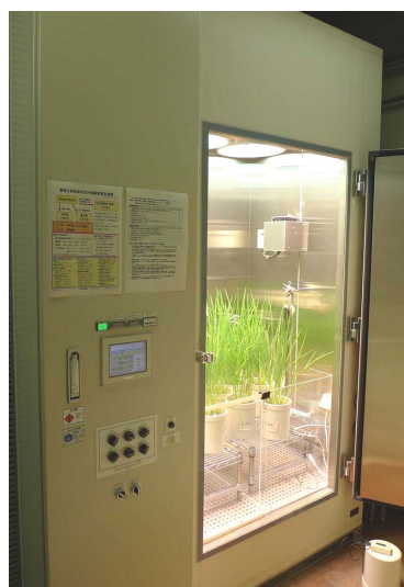
図1 CO 2 付与装置付きグローブチャンバー
